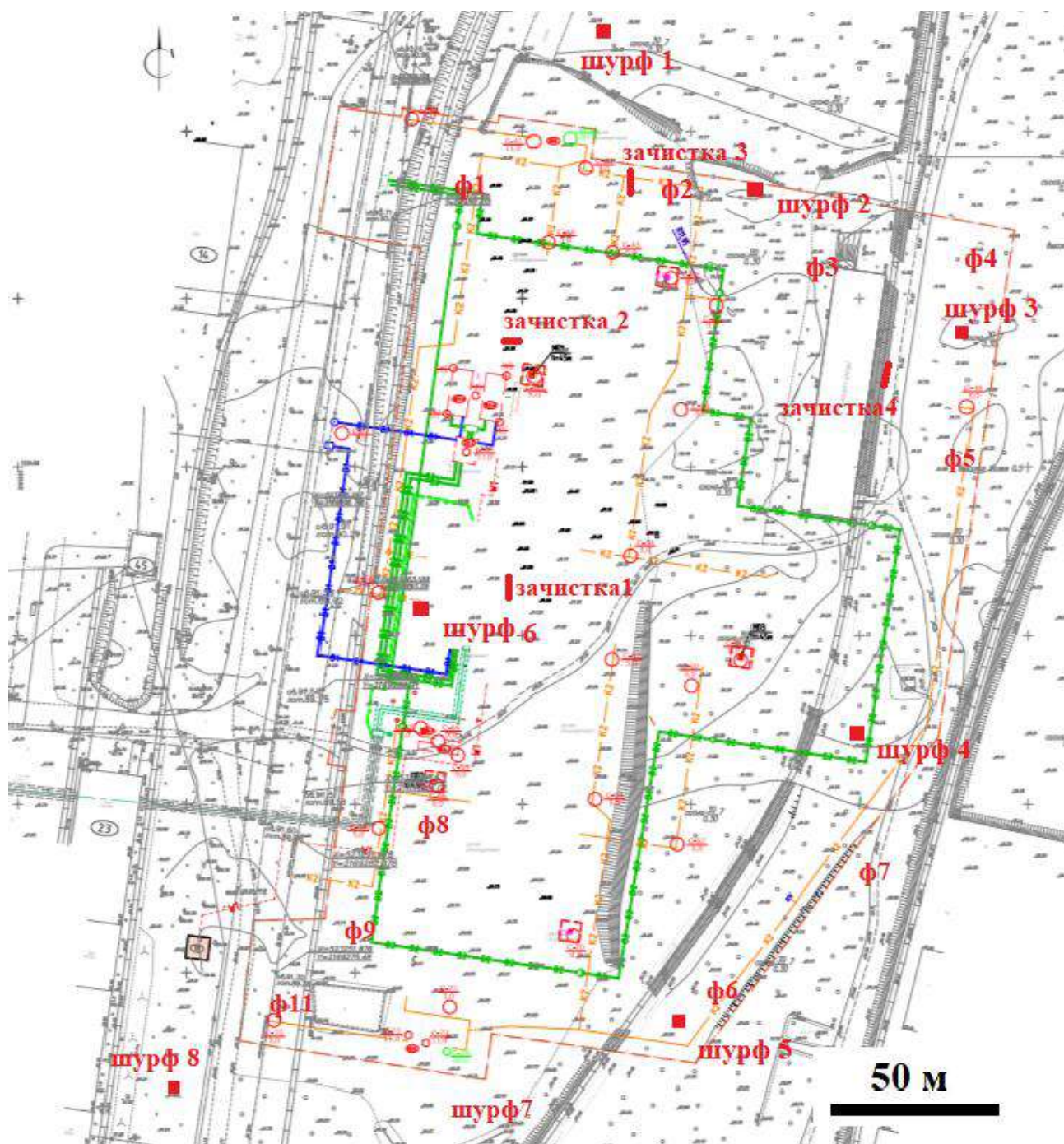
Ил.32. Нижегородская обл., Володарский р-н, п. Юганец, ул. Парковая. План участка строительства цеха и линии ж/д путей, с указанием мест постановки шурфов, зачисток обнажений и точек фотофиксации.
